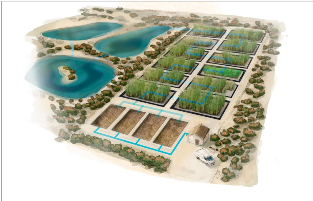
Figura 13. Esquema genérico de un Filtro Verde.
